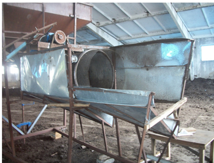
Рис. 1. Конструкція установки для сепарації компостної суміші (варіант)
