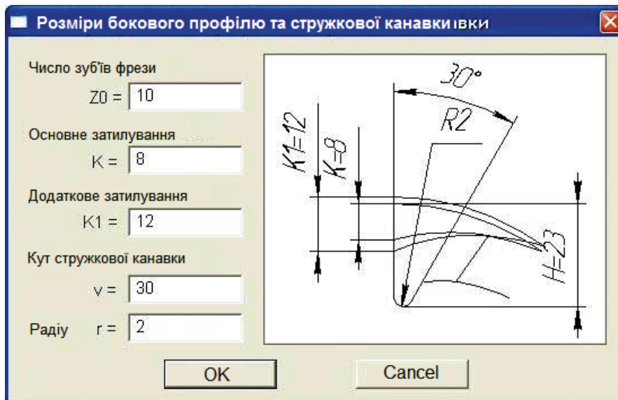
Рис. 4. Параметри бічного профілю зуба й стружкової канавки
