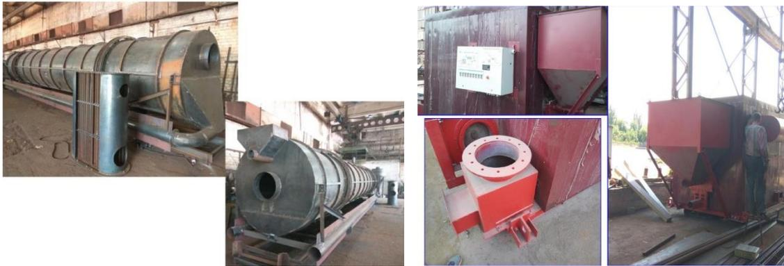
Рис. 6. Фотографии сушильного барабана и теплогенератора в процессе производства и монтажа.
