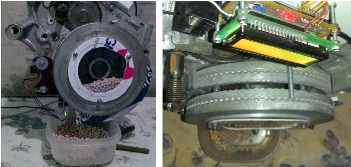
Рис. 2. Лабораторна установка щілинного механічного висівного апарату точного висіву
