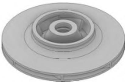
Рис. 23. Тривимірна спрощена розрахункова модель колеса
