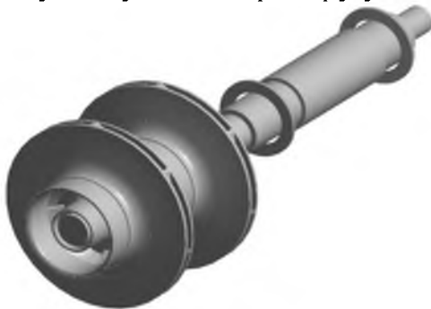
Рис. 13. Тривимірна розрахункова модель ротору у зборі
