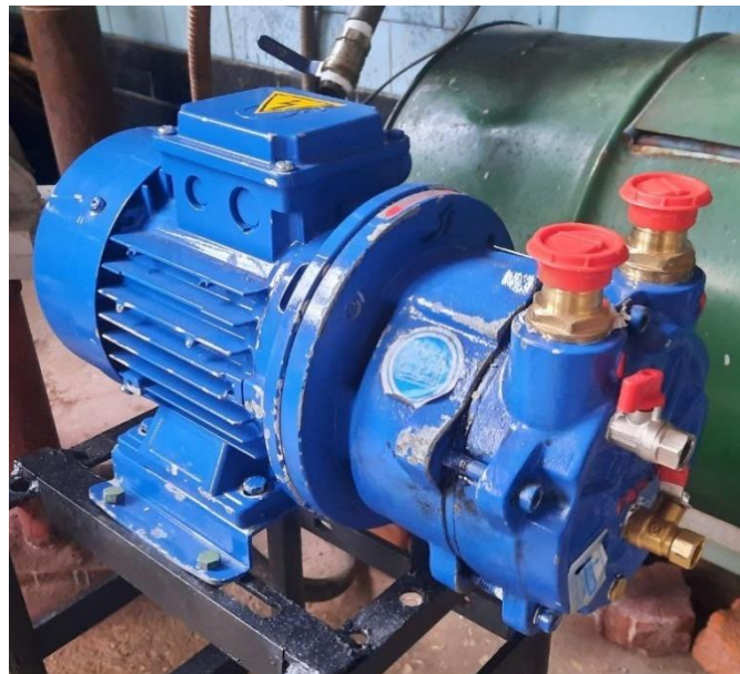
Рис. 8. Рідинно-кільцевий вакуумний насос PVM 115\050 ADKPK0
