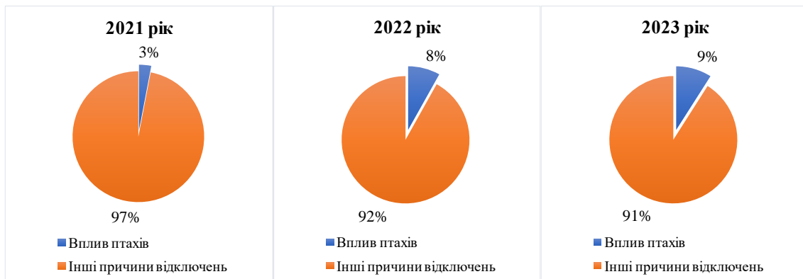
Рис. 2. Частка відключень через птахів від загальної кількості аварій підстанцій Сумського регіону
