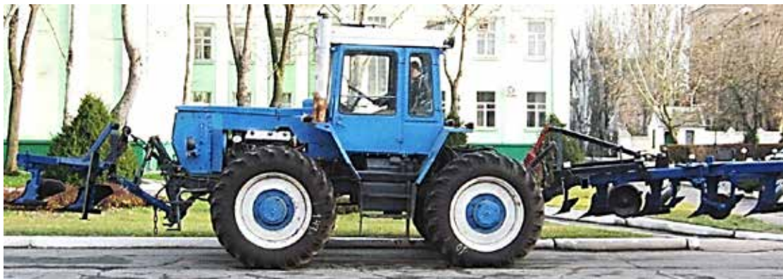
Рис. 1. Орний агрегат з фронтальним плугом без опорного колеса
