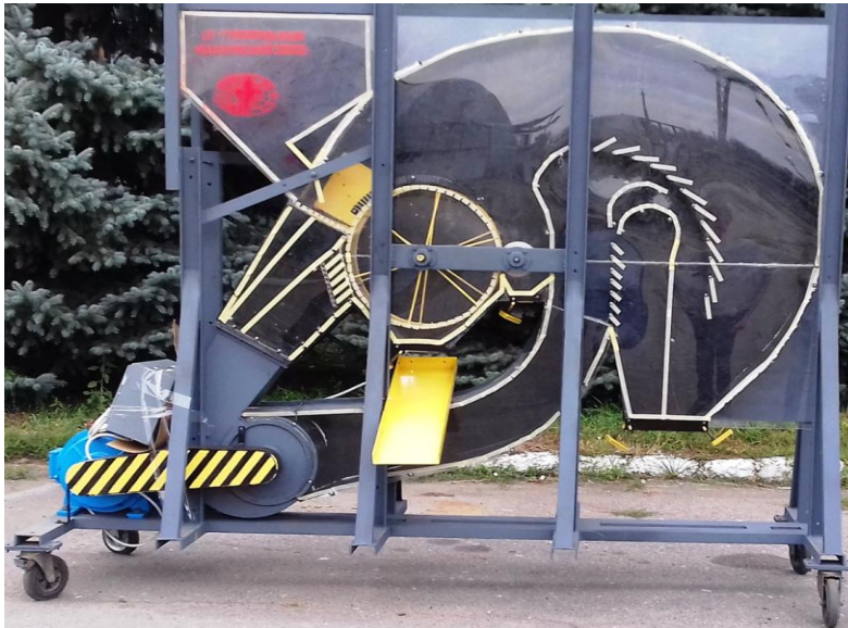
Рис. 1. Лабораторно-виробничий стенд пневморешітного сепаратора олійної сировини соняшнику
