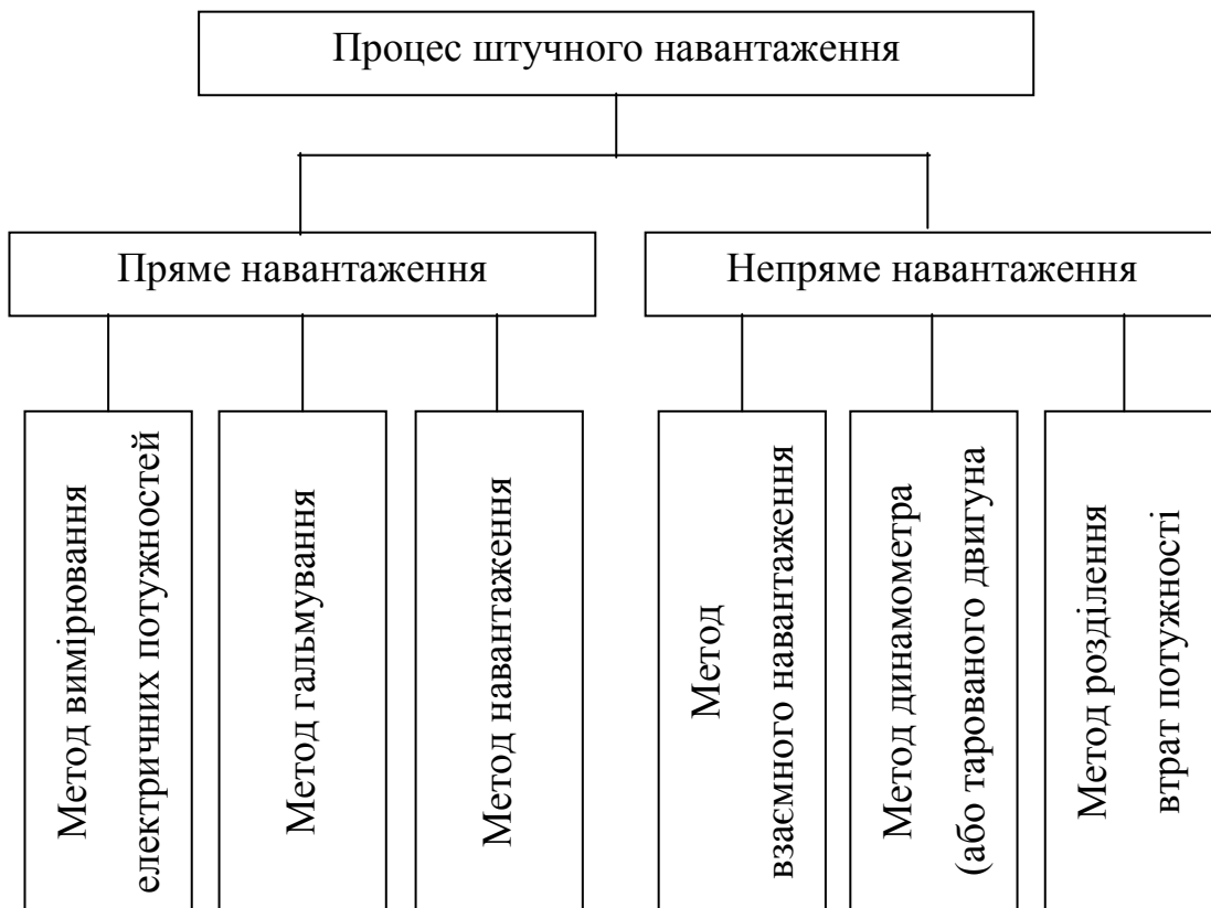
Рис. 2. Методи здійснення процесу штучного навантаження асинхронного електродвигуна
