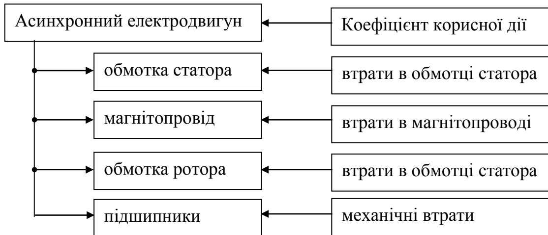
Рис. 1. Діагностичні параметри асинхронного електродвигуна
