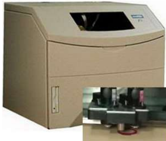
Рис. 5. Створення восківки на 3D-принтері.
