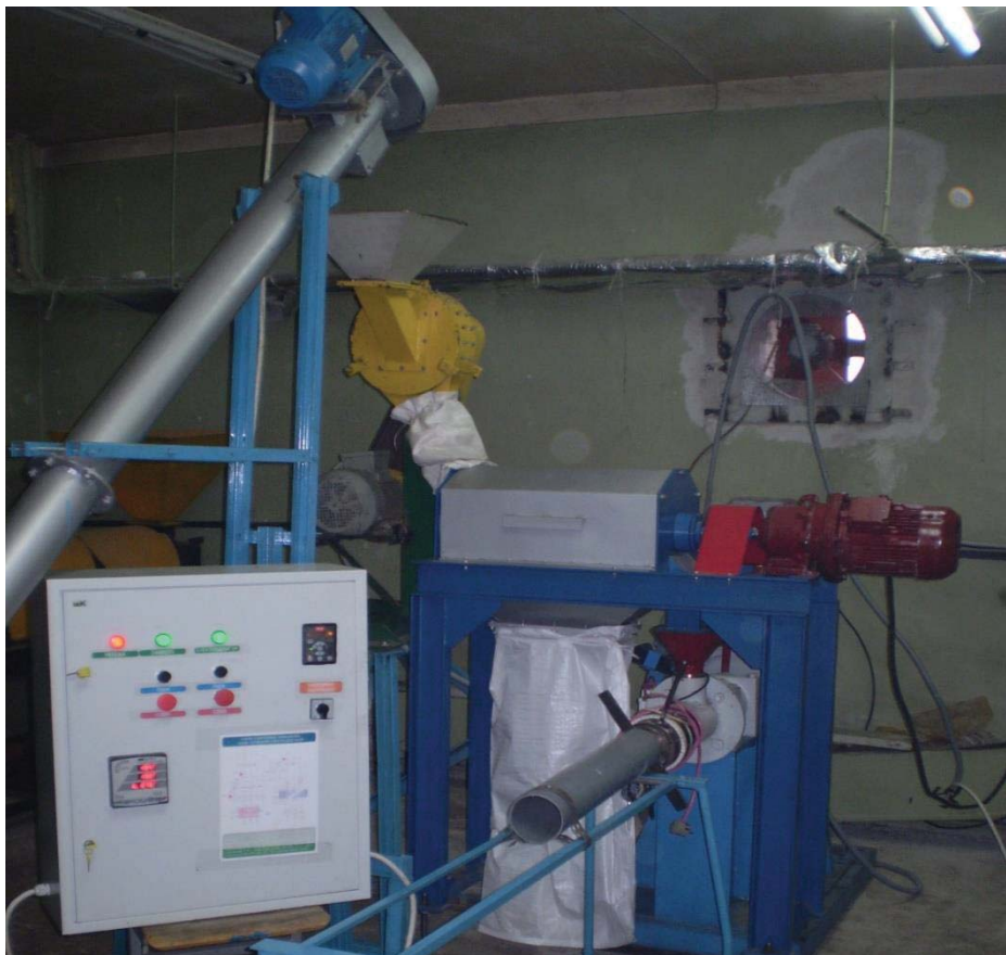
Рис. 2. Механізована технологічна лінія переробки макух з насіння олійних культур з одержанням протеїнових добавок і твердого біопалива
