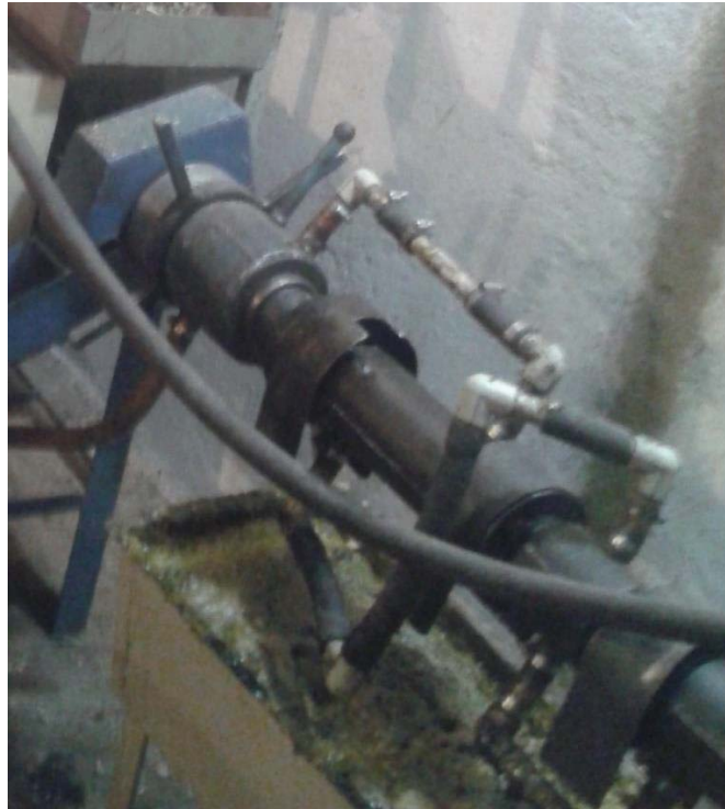
Рис. 2. Фрагмент робочих органів, до складу якого увійшли розроблені камера дожиму та орган остаточного формування брикету з системою контролю температури та відбору технічних олій
