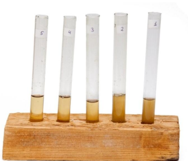
Рис. 7. Прозорість очищеної рицинової олії в залежності від часу витримки 1 – віджата олія; 2 – гідратована віджата олія; 3, 4, 5 – олія після витримки в електрофлотаційній камері відповідно 300 с, 600 с та 1000 с
