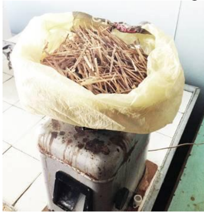
а) зважування зразків солон'яної підстилки ( m_{3-6}=35\text{г} , m_{6-10}=21\text{г} )
