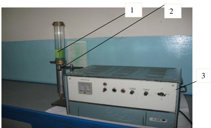
Рис. 1. Лабораторна установка для обробки біодизеля ультразвуком: 1 – ємність з біодизелем; 2 – магнітострикційний випромінювач; 3 – генератор імпульсів
