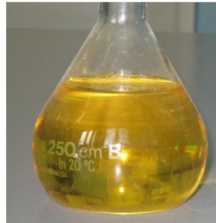
Рис. 3 Ємність з біодизелем обробленим ультразвуком після шести місяців зберігання
