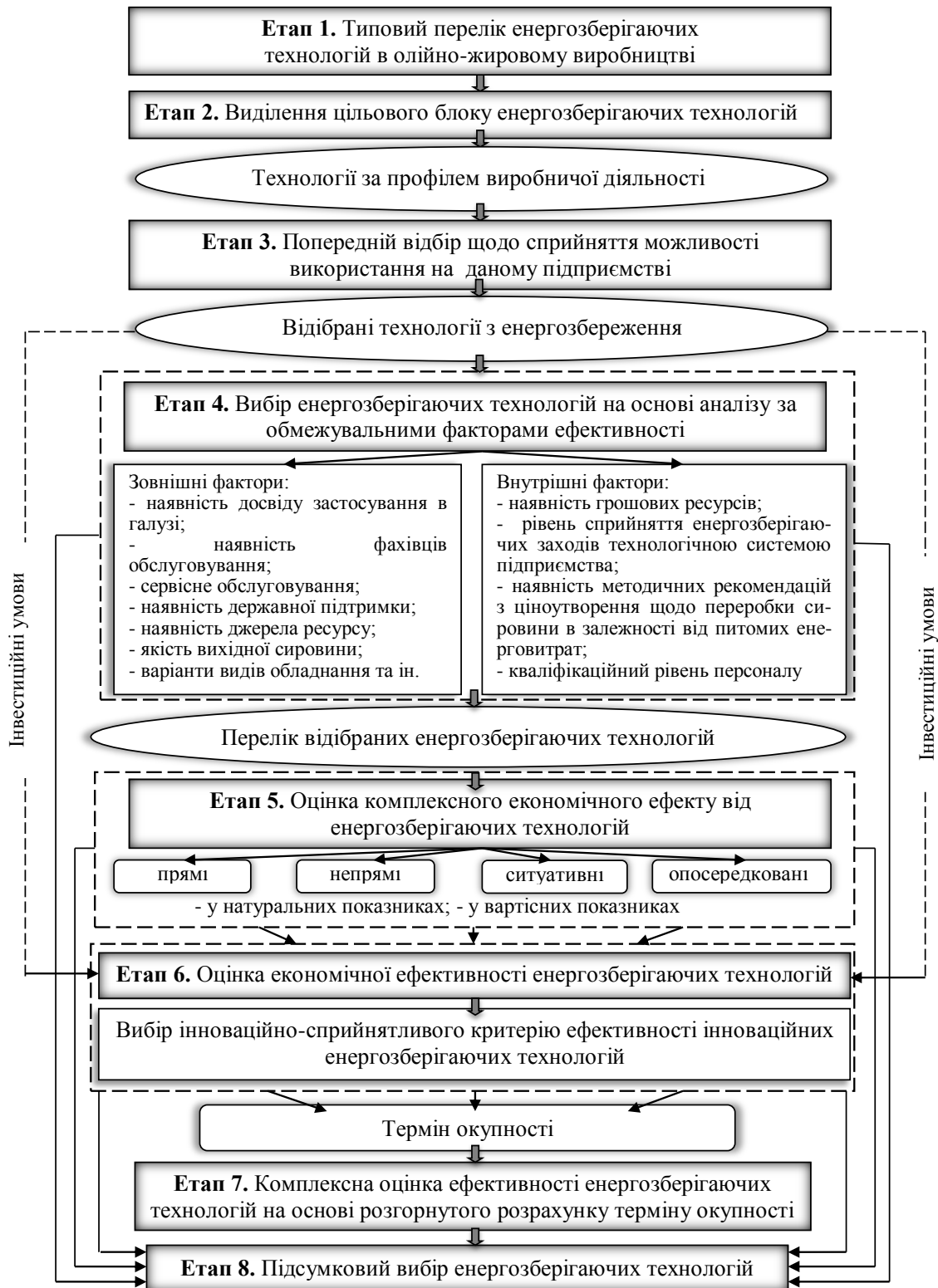
Рис. 1. Структурно-логічна модель вибору ефективних енергозберігаючих технологій.
