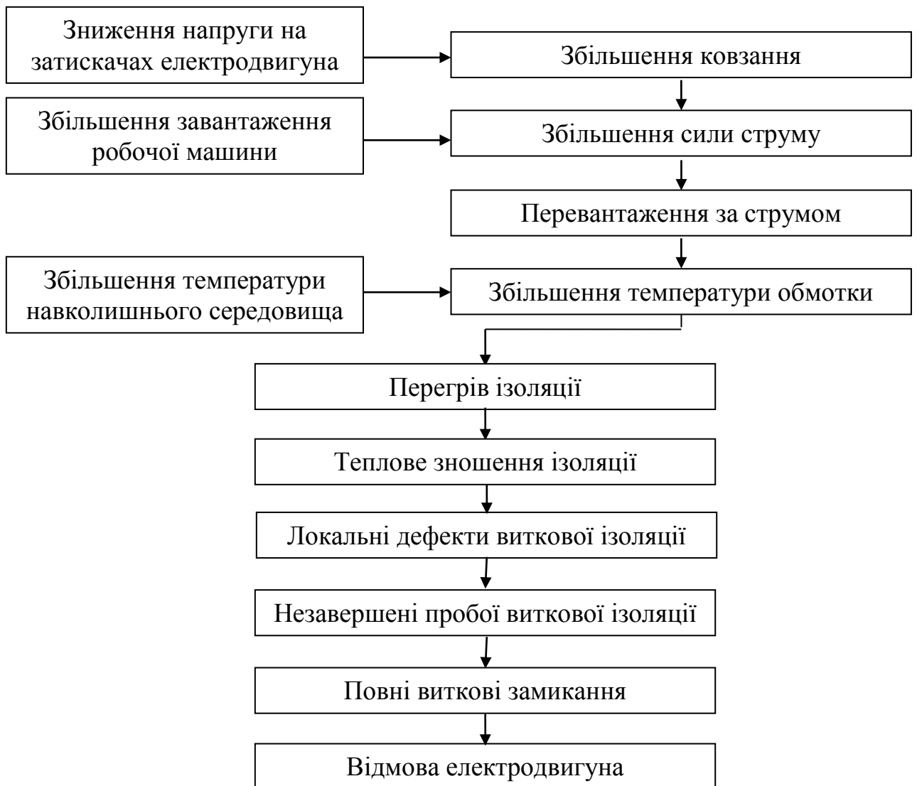
Рис. 1. Причинно-наслідковий зв'язок зниження напруги на затискачах асинхронних електродвигунів потокової технологічної лінії
