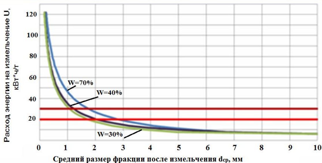
Рис. 5. Зависимость потребления энергии при одностадийном измельчении от глубины измельчения для биомассы разной влажности
