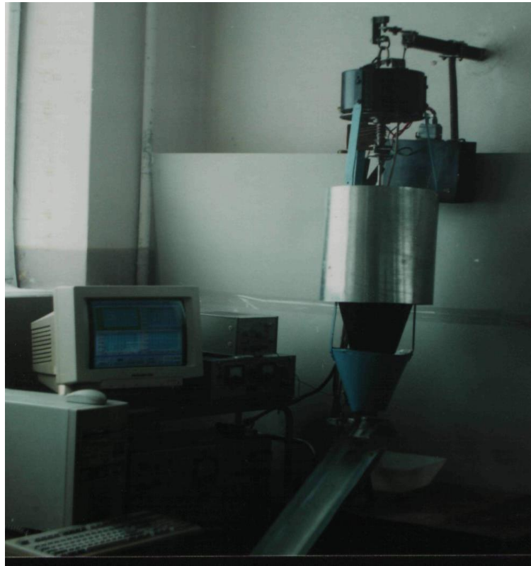
Рисунок 2. Загальний вигляд експериментальної установки для дослідження індивідуального дозатора комбікормів
