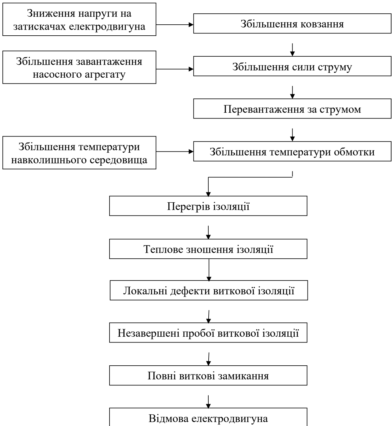
Рисунок 1. Причинно-наслідковий зв'язок зниження напруги на затискачах асинхронних електродвигунів насосних установок
