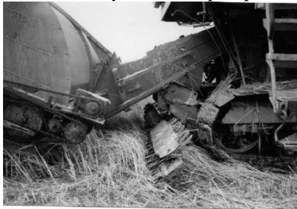
Рисунок 4. Ріжучий пристрій сегментного типу з транспортуючим механізмом
