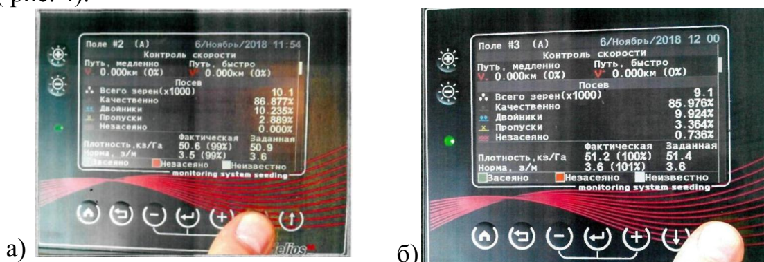
Рис. 4. Статистичні характеристики результатів роботи системи контролю висіву соняшнику: а – по завершенні висіву агрегатом на першому гоні; б – після закінчення висіву агрегатом на другому гоні
