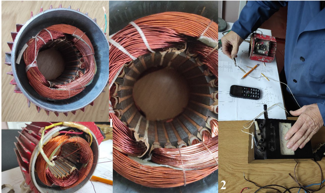
Рисунок 5. 1 – укомплектований статор електродвигуна; 2 – перевірка цілісності обмоток та правильності їх підключення мегаомметром
