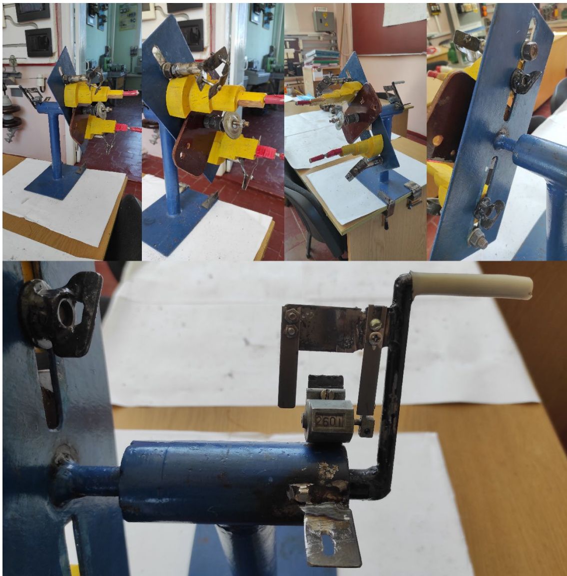
Рисунок 4. Пристрій намотування обмоток електродвигуна
