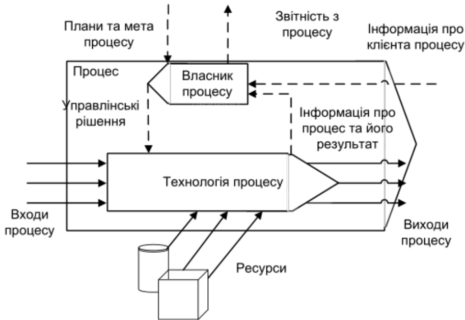
Рисунок 2. Типова схема управління процесами (на виробництві)
