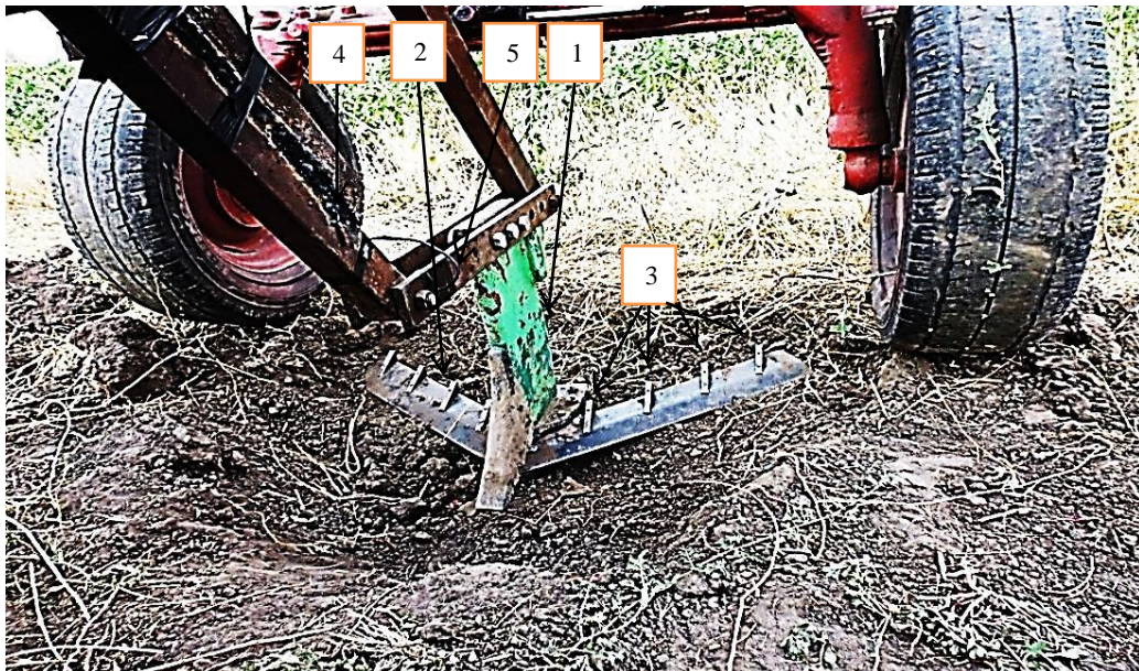
Рис. 1. Загальний вигляд експериментальної польової установки: 1 – плоскоріз КПГ – 2-150; 2 – експериментальний робочий орган; 3 – розпушувачі; 4 – паралелограмний механізм; 5 – тензоланка
