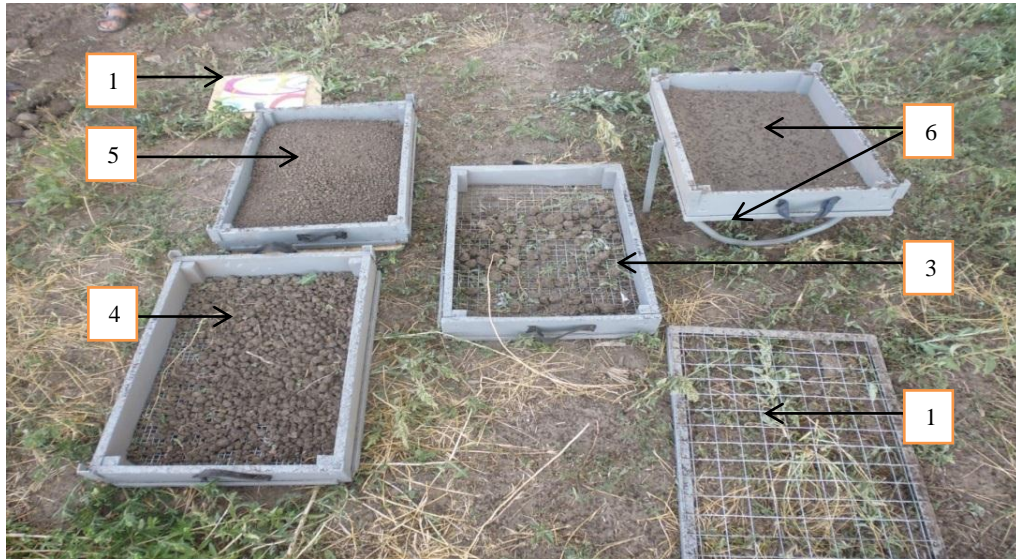
Рис. 2. Визначення якості кришення ґрунту: 1 – ваги (з похибкою \pm 50 г); 2 – грати для брилистої фракції розміром > 50 мм; 3 – грати для фракції розміром > 25 мм; 4 – грати для фракції розміром > 10 мм; 5 – грати для фракції розміром > 1 мм; 6 – піддон для пилуватої фракції ( < 1 мм) з підставкою та фіксатором
