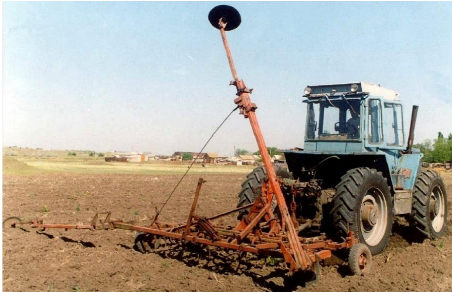
Рис. 1. Агрегат для прокладання слідів ПТК
