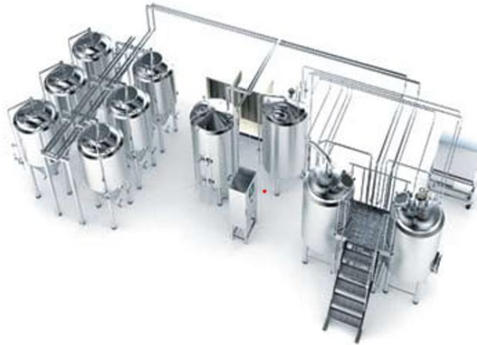
Рис. 1. Технологічний комплекс обладнання для варіння та ферментації пивного сусла Micro Cube
