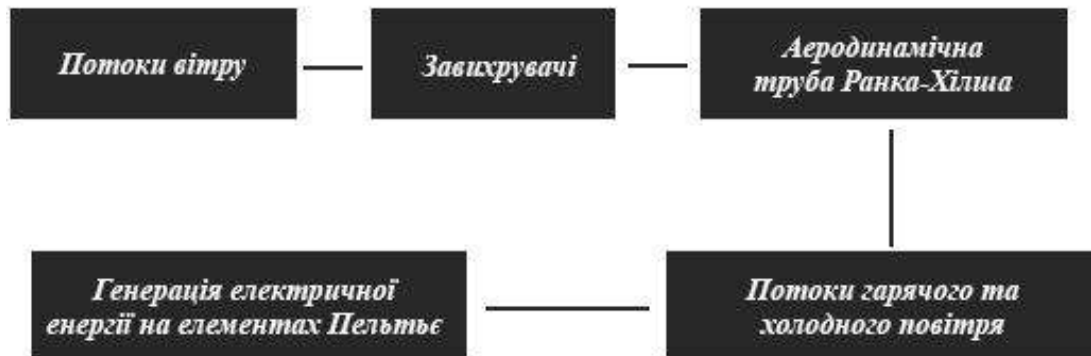
Рис. 2. Блок-схема процесу генерації електричної енергії розробленого вітрогенератора
