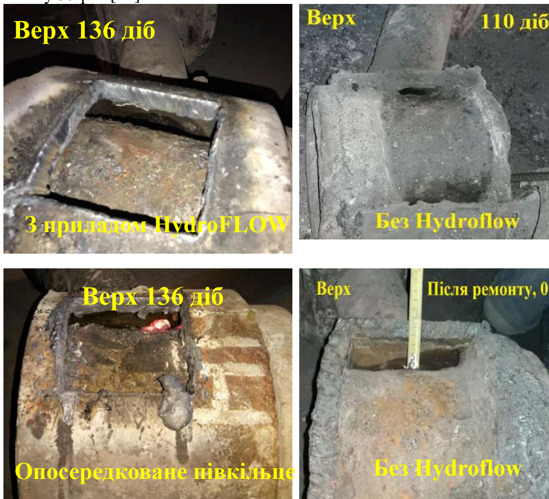
Рис. 2. Стан елемента півкільця
