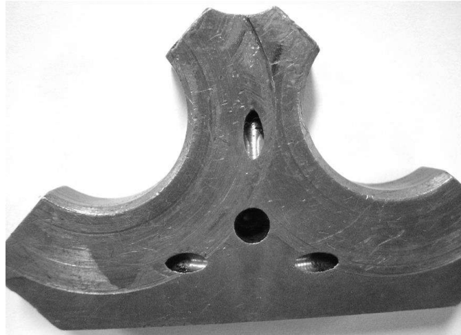
Рис. 1. Характерне зношування платику торцевого ущільнення
