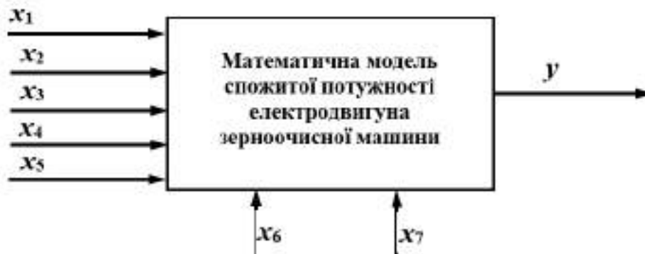
Рисунок 1. Математична модель спожитої потужності електродвигуна зерноочисної машини
