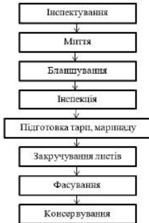
Рисунок 3. Блок-схема виробництва консервованого виноградного листа
