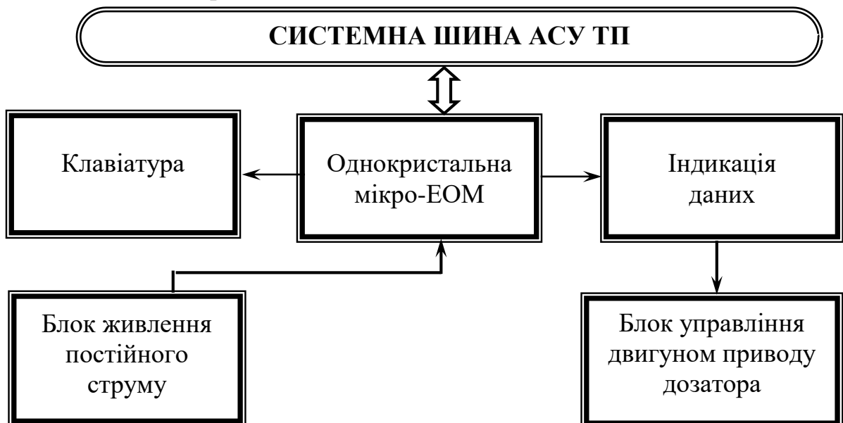
Рисунок 3. Структурна схема функціонування автоматизованої кормової станції
