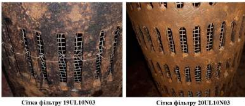
Рисунок 9. Стан встановлених сітчастих фільтрів на початку випробувань. Ліворуч – фільтр НС19, праворуч – фільтр НС20.
