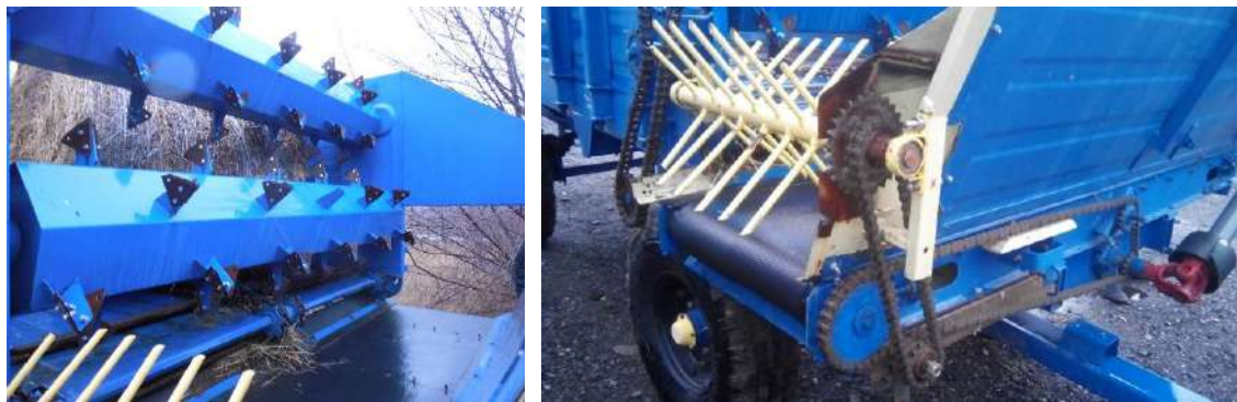
Рисунок 1. Загальний вид обладнання для технологічного процесу внесення солом'яної підстилки з роторно-пальцевим робочим органом
