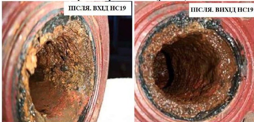
Рисунок 2. Стан відкладень на фланцях підведення води в системі водоохолодження електродвигуна НС19 після випробувань (Ліворуч - вхід, праворуч - вихід).
