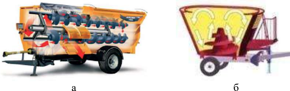
Рисунок 1. Технологічна схема кормороздавачів-змішувачів з горизонтальними (а) і вертикальними (б) робочими органами
