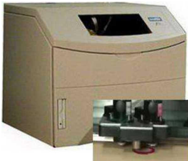
Рисунок 4. Створення восківки на 3D-принтері
