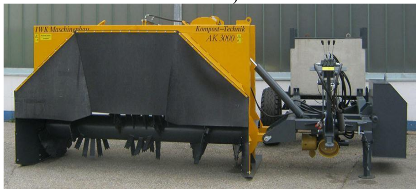
Рисунок 2. Аератори компостної суміші: а) самохідний аератор компанії «Menart»; б) самохідний аератор компанії «IWK Metall- und Maschinenbau GmbH».
