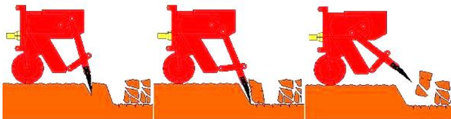
Рис. 1. Схема копача з коливальним рухом робочих органів (VANGATRICI, Італія) (16)
