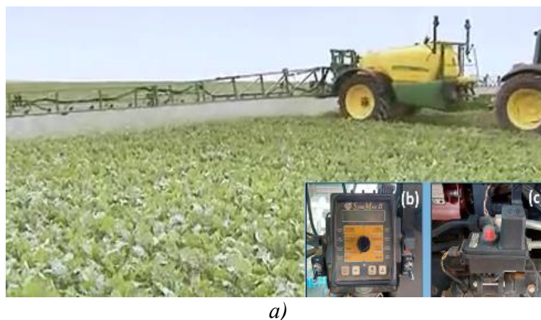
Рис. 1. Штанговий обприскувач M700, використаний для тестування продуктивності розпилення (а); Регулятор норми внесення Micro-Trak MT-2405F II, встановлений у 2024 році (b); Регулюючий клапан TeeJet® 346BPR-2F-03, використаний у 2024 році (c).
